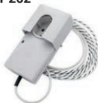
Der **Aquastop** wird als Zwischenstecker in die Steckdose vor die Wasch- oder Spülmaschine eingesetzt. Sobald der am Boden montierte Sensor geringste Mengen Flüssigkeit misst, schaltet der **Aquastop** das eingesteckte Gerät ab. Gleichzeitig setzt der Warnton ein und die Warn-LED leuchtet rot. Dadurch wird auch der Wasserstop des Gerätes aktiviert.
