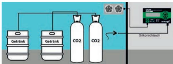
Der CO<sub>2</sub>-Warnmelder GX-D500P ist ein prof. Warngerät mit fest eingestellten Alarmschwellen bei 1,5% vol. CO<sub>2</sub> für Voralarm und 3,0% vol. CO<sub>2</sub> für Hauptalarm. Durch das Ansaugsystem, das den zu überwachenden Raum mit einem dickwandigen Silikonschlauch verbindet
