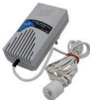
Der **SHT 241** Wassermelder hat an einer 2,8 Meter Leitung einen Schwimmerschalter. Dieser robuste Schwimmerschalter ist besonders für Schmutzwasser oder auch andere Flüssigkeiten geeignet (z.B. Heizöl, Diesel, Pflanzenöl, Schmieröl, u.a.). Der Schaltkontakt des Schwimmers schließt ab ca. 4 cm Pegelhöhe und aktiviert den Eingang des Wassermelders.
