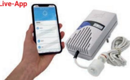
Der **WWD 240** Wassermelder ist ein Plugin-Steckdosengerät, zur Montage das Gerät einfach in eine Steckdose einstecken und den Wassersensor am Boden montieren. Bei Bedarf können Sie die Sensorleitung bis zu 50 m mit einem LIYY-Kabel (max. 2 x 0,14mm<sup>2</sup>) verlängern. Das Kabel sollte nicht parallel zu 230 V Netzkabeln verlegt werden.
