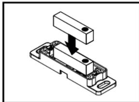
Anschließend den Gehäusedeckel aufdrücken, bis die Laschen einrasten.
