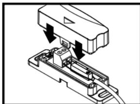
Magnet und Schaltkontakt werden mit den Schrauben am Fenster befestigt. Die Distanzplatten dienen zum Höhenausgleich, damit Magnet und Kontaktschalter bei geschlossenem Fenster auf gleicher Höhe sind. Der Abstand zwischen Magnet und Kontaktschalter darf nicht größer als 0,5 cm sein.
