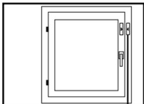
2. WICHTIG! Bei der Montage von Magnet und Magnetschalter müssen die roten Punkte auf gleicher Höhe liegen. Nur in dieser Position kann der Magnet (Magnetfeld) den Reed-Kontakt schalten.
