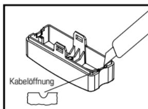
Der Gehäusedeckel wird auf das Bodengehäuse aufgesetzt, bis die Laschen einrasten.
