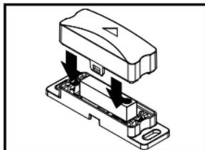
Öffnung am Gehäusedeckel mit dem Messer vorbereiten. Bitte beachten Sie, auf welcher Seite die Öffnung der Oberschale eingeschnitten wird. Dies hängt von der Position des Kabel-Magnetschalters am Fenster ab. Die Kabelöffnung nur so groß schneiden wie nötig, damit das Kabel durch den Gehäusedeckel fixiert wird.
