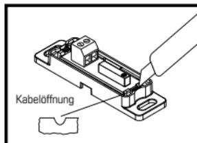
Das Steuerkabel an der Klemme anschließen.
