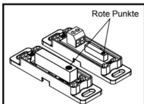
Der Magnet wird in die Unterschale eingesetzt.
