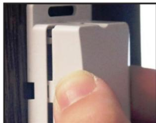
7.1 Öffnen Sie den Deckel des Senders, indem Sie den Deckel auf Höhe der LED seitlich zusammendrücken, so dass sich die Laschen aus dem Unterteil lösen. Nehmen Sie den Deckel vorsichtig ab. Sie sollten die Batterie wechseln, ohne den Sender vom Fenster zu demontieren.
