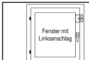
4.2.6 Befestigen Sie Magnet und Sender durch die mitgelieferten Schrauben am Fenster. Beachten Sie dabei, dass die Pfeile auf den beiden Gehäusen zueinander zeigen und der Abstand zwischen Magnet und Sender nicht größer als 5 mm sein darf.
