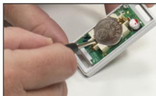
**Schieben** Sie die frische Knopfzelle **Batterie CR 2032 / 3V** **unter** die messingfarbenen **Batterie-****haken** ein und drücken dann die Knopfzelle nach unten. Achten Sie dabei auf die Polung: die Beschriftung der Knopfzelle mit dem **+** muss nach oben zeigen und lesbar sein.
