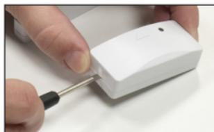
Hebeln Sie die verbrauchte Knopfzelle mit beliebigem Schraubendreher aus ihrem Halter. Fahren Sie von oben mit dem Schlitz-Schraubendreher zwischen Kontakt und Knopfzelle und bewegen den Griff nach außen, die Knopfzelle springt aus ihrem Halter.
