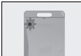
**TIPP:** Montieren Sie den Sender so, dass seine LED in Richtung Empfänger „sieht“. So sind die aktiven Antennenflächen bestmöglich aufeinander ausgerichtet.
