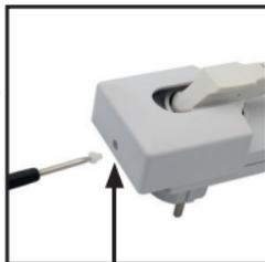
Stecken Sie den Netzstecker der Klimaanlage in die Steckdose des Funk-Empfängers. Schieben Sie die Netzstecker-Sicherung über und befestigen Sie diese mit der Kunststoffschraube. Zusätzlich müssen Sie die Schraube durch den mitgelieferten Aufkleber versiegeln. Die Netzstecker-Sicherung verhindert das unbeabsichtigte Umstecken des Netzsteckers
