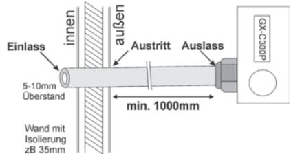
(In zu überwachenden Räumen mit Staubbelastung wird „innen“ wesentlich mehr Schlauch benötigt, um den Staubfilter mit Mindestverlegeradius anzuschließen.)
