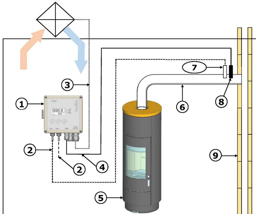
Abb. 4: Anschlusskizze DS 01 L Einsatzgrenzen der Komponenten
