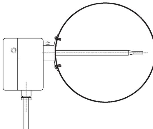
Abb. 8: Temperaturmessadapter montiert
