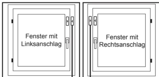
Der Kabel-Magnetschalter muss je nach Fensteranschlag am Fenster so montiert werden, dass sowohl beim Kippen als auch beim Öffnen des Fensters der Kontakt schaltet.
