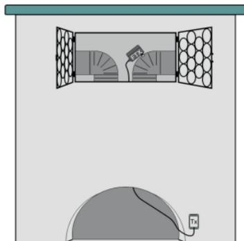
in drucklosen Medien verwendet werden. Bei der Verbrennung ungeeigneter Brennstoffe, z.B. Kunststoffe, können aggressive Gase entstehen, die den Fühler zerstören können.
