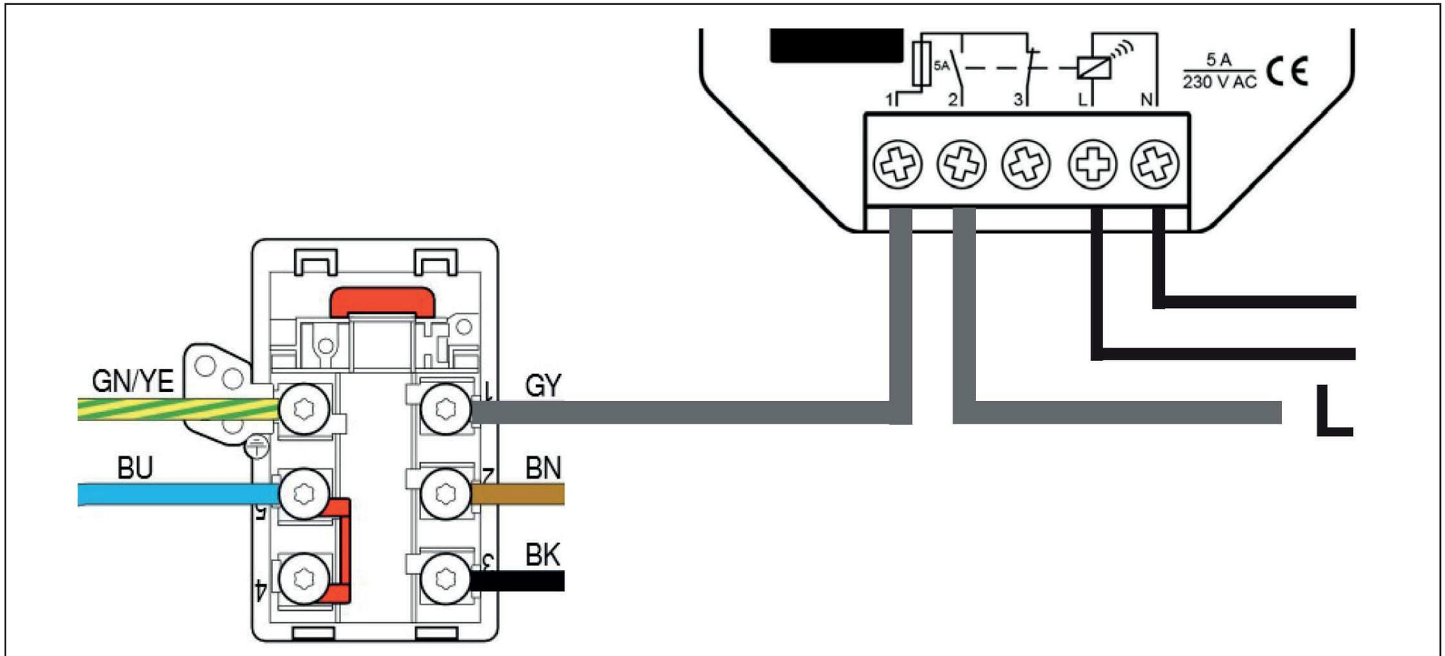
Muldenlüfter von Bosch, Neff, etc. haben oft das Herdanschlussfeld mit eigenem Anschluss für den Lüftermotor. Die Brücke muss entfernt werden, es wird ein Leiter von einem der L-Anschlüsse abgezweigt und über die Klemmen 1 und 2 des FDS 100 auf den L1-Eingang des Herdanschlussfeldes geschaltet.
