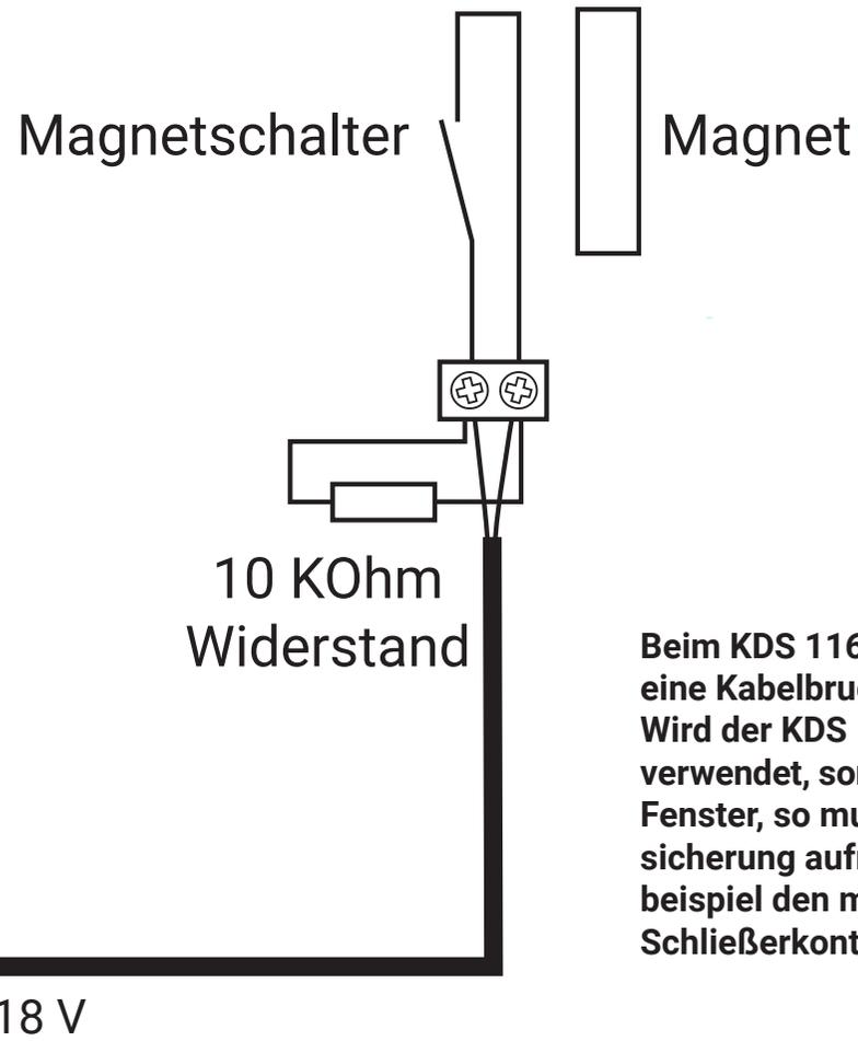
Beim KDS 116 ist in dem mitgelieferten Kabel-Magnetschalter eine Kabelbruchsicherung (10 KOhm Widerstand) integriert. Wird der KDS 116 nicht mit dem original Kabel-Magnetschalter verwendet, sondern mit einem integrierten Schaltkontakt am Fenster, so muss folgendes beachtet werden: Um die Kabelbruchsicherung aufrecht zu erhalten, müssen Sie nach Anschlussbeispiel den mitgelieferten 10 KOhm Widerstand parallel zum Schließerkontakt anschließen.
