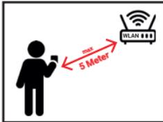
**Zur Erstinstallation sollten Sie nicht mehr als 5 Meter vom WLAN-Router entfernt sein!**
