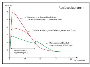
Kurzschluss-Strom begrenzt. Nach 0,7 Sekunden hat sich das Magnetfeld längst aufgebaut, der Motor dreht und verbraucht selbst den Strom, dann erst schaltet ein Relais parallel zum Leistungswiderstand die Energieversorgung voll durch. Der ASB selbst hat bei laufender Maschine nur noch die Funktion einer normalen Leitung und der Leistungswiderstand kann wieder abkühlen.
