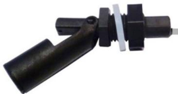
Der Klapp-Schwimmerschalter aus Kunststoff (PP und ABS) ist zuverlässig, wartungs- und verschleißfrei und „von innen“ in einem Tank, Kanister, etc. zu montieren. Dieser Schalter wird von ES gebaut: Ein Reedkontakt wird mit dem hochwertigen Kabel verlötet und zusammen in dem Schaft mit Wepuran® vergossen. Mit der 230-Volt-Version, die nicht primär für den Einsatz an Schabus Wassermeldern gedacht ist, lässt sich z.B. direkt ein 230-V-Relais im Sicherungskasten schalten.
