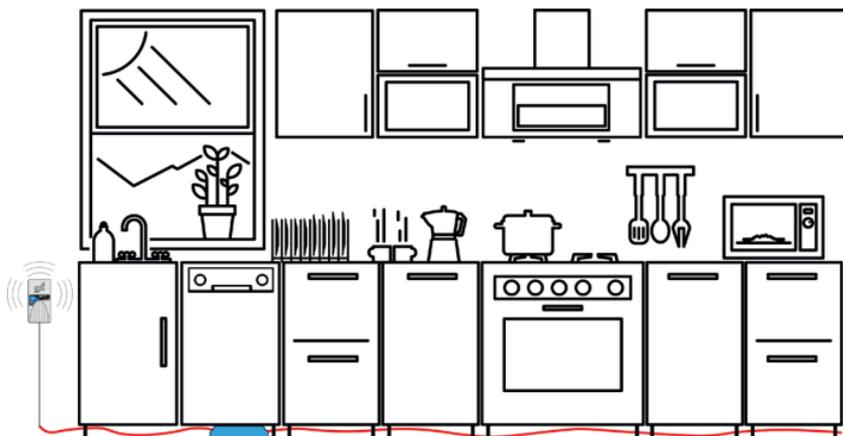
Sie können die **Sensorleitung** (hier **rot dargestellt**) bequem, unauffällig und großflächig verlegen. So decken Sie den gesamten Bereich zuverlässig ab und müssen nicht die tiefste Stelle suchen, an der sich das Wasser sammeln würde.
