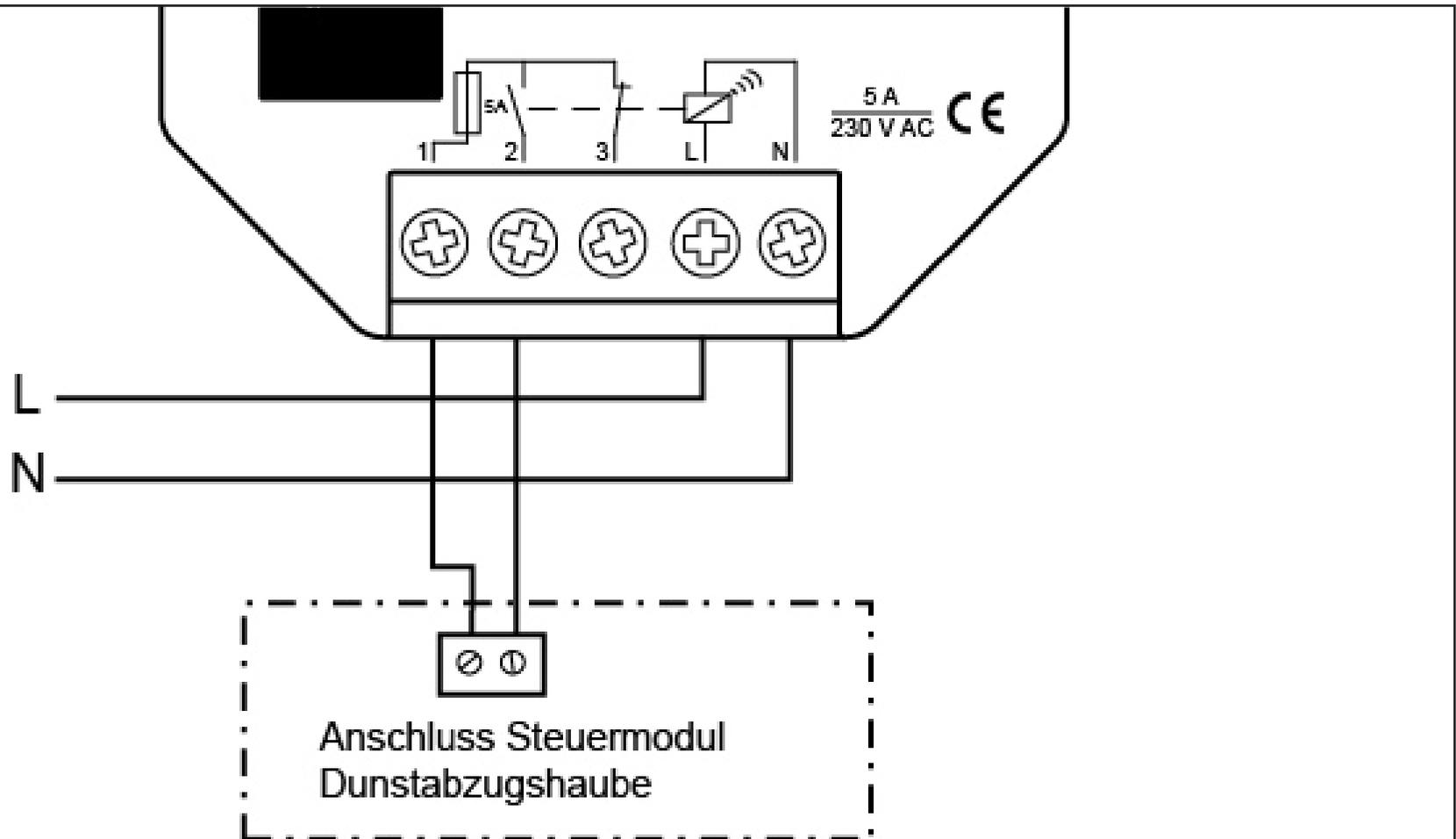
Einige Dunstabzugshersteller bieten externe Anschlussmodule zur separaten Ansteuerung des Lüftermotors an, z.B. BORA Professional Home In, Miele KMDA7774, uvm. Mit dem potentialfreien Relaiskontakt des FDS 100 Empfängers ist dies zu realisieren. Mit Anschluss an einen Steuerkontakt wird der FDS 100 auch BLDC-fähig.
