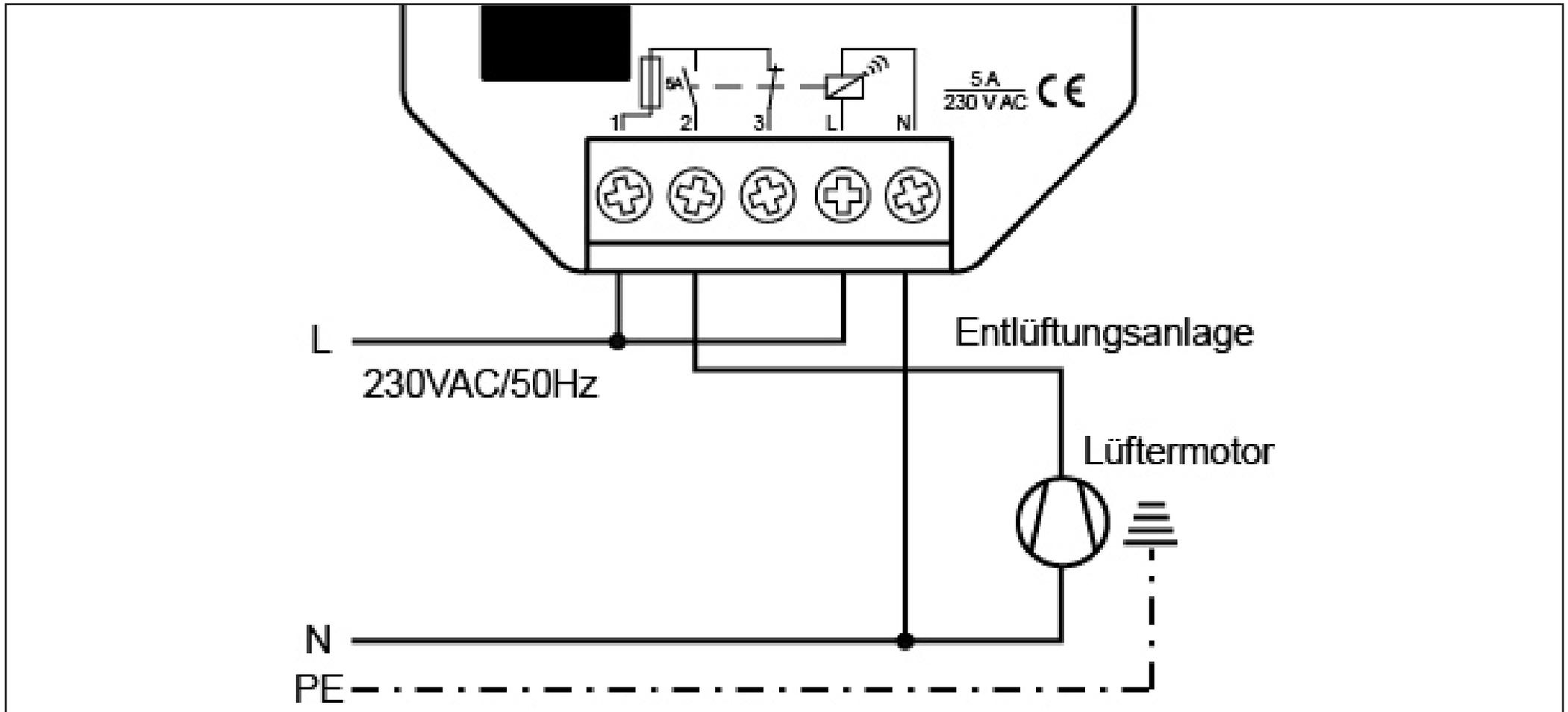
Bei geschlossenem Fenster schaltet der Empfänger den Lüftermotor der Dunstabzugshaube oder Entlüftungsanlage stromlos. Der Empfänger kann Auf- oder Unterputz in einer Verteiler-, Schalter- oder Steckdose mit mind. 60 mm Ø eingebaut werden. Die seitlichen Befestigungsglaschen am Empfänger können bei Bedarf weggebrochen werden. Der Einbau in die Dunstabzugshaube selbst sollte im Sinn einer guten Funkverbindung vermieden werden.
