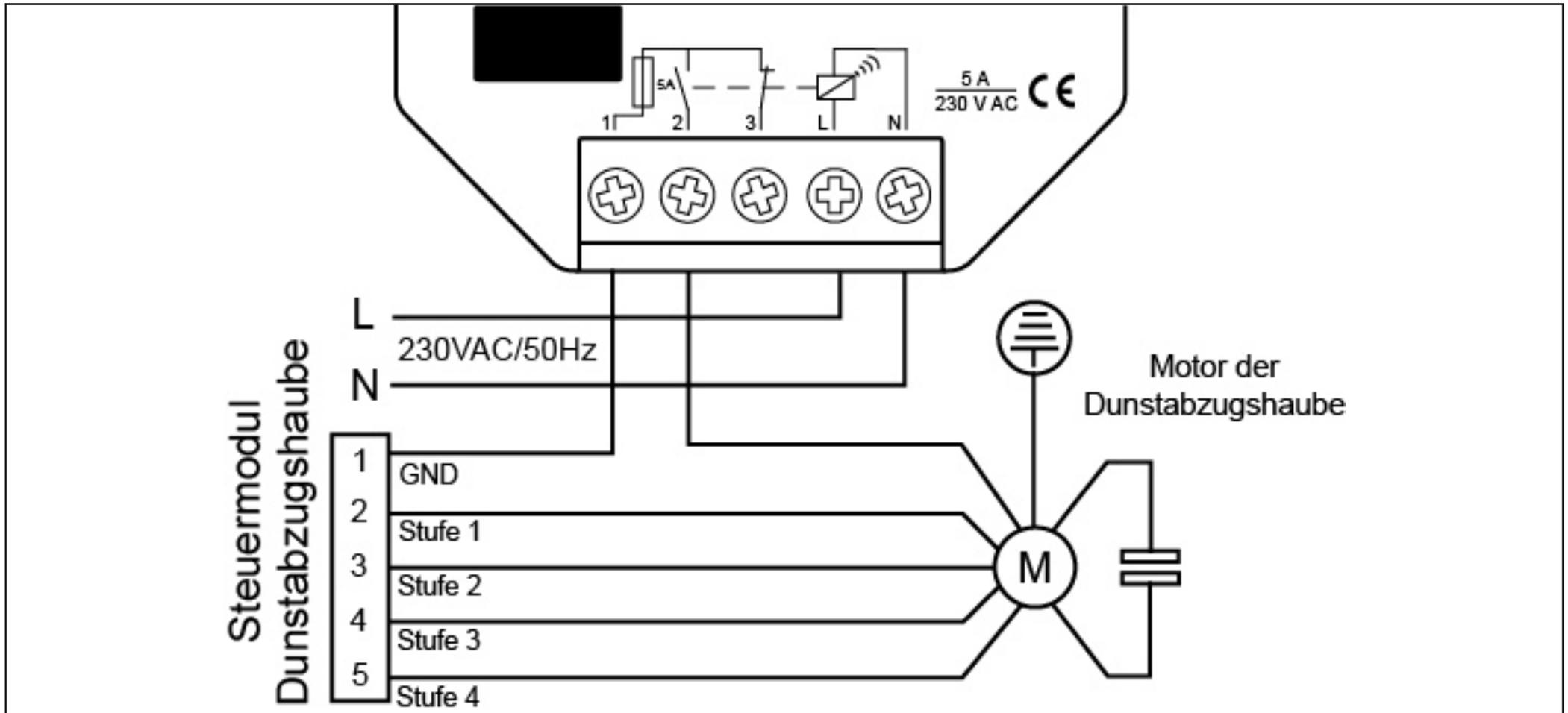
Bei älteren Dunstabzugshauben mit mechanischer Gebläsestufenschaltung wird der Empfänger in die Lüftermotorzuleitung zwischengeschaltet, damit die Beleuchtung der Dunstabzugshaube unabhängig von der Fensterstellung funktioniert.
