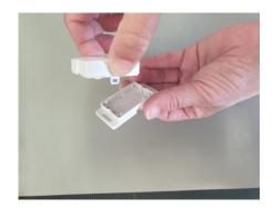
Batteriewechsel: man legt den Sender vor sich hin dass die Antenne (Schwarzes Kabel) rechts unten sich befindet. (siehe Bild) mit dem mitgelieferten Schraubenzieher fährt man senkrecht in den Hohlraum zwischen Batterie und Batteriehalter und hebelt die Batterie vorsichtig nach oben. Die neue Batterie drückt man von oben einfach rein.
