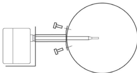
DIN 7500 M 5 x 12 am Rauchrohr befestigt.
