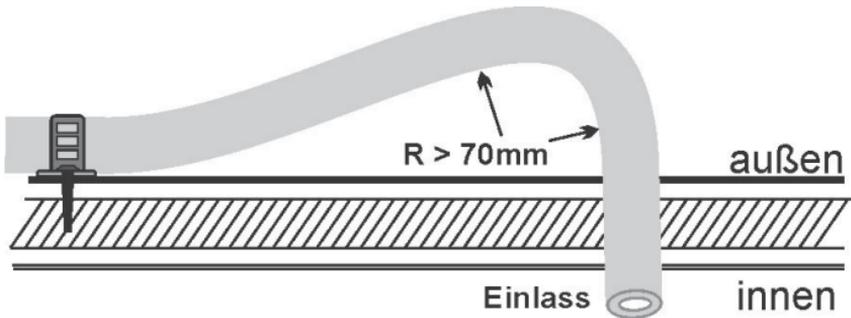
Abhängig von der Position des Loches für den Schlauch und dem Ort der Befestigung des Warngerätes kann der Schlauch entsprechend gekürzt werden. Die min. Schlauchlänge von 1000 mm zwischen Austritt (Loch) und Auslass (GX-D500P) ist bei heißen / kalten Räumen einzuhalten.
