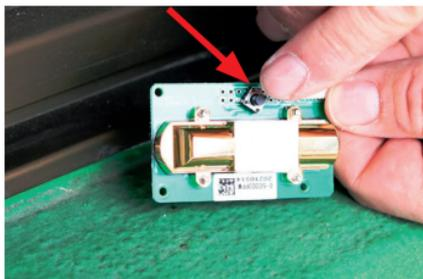
Bringen Sie den Sensor jetzt an **echte frische Luft** nach draußen und belassen ihn dort für **mind. 30 Minuten**, idealerweise an einem schattigen Ort, zumindest nicht in praller Sonne. Entfernen Sie sich vom Sensor um durch Ihre ausgeatmete Luft die Werte nicht zu verfälschen. Sorgen Sie für einen isolierenden Untergrund auf dem der Sensor liegen darf.
