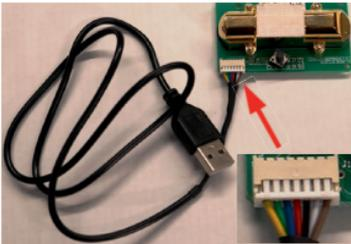
Verbinden Sie nun den USB-Stecker mit einer 5 Volt USB Spannungsquelle, bspw. ein Netzteil, ein Laptop, eine Powerbank, etc. und schalten es ein bzw. verbinden Sie es mit dem Stromnetz in der Nähe eines Fensters oder gleich draußen an der frischen Luft, z.B. auf der Terrasse.
