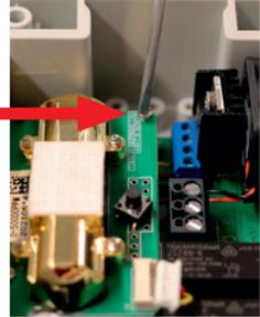
Modul, die sich in den gegenüberliegenden Ecken befinden. Die Schrauben sind sehr klein (M2) und können leicht verloren gehen. Das Sensor-Modul ist nun vom Hauptgerät getrennt und Sie können es heraus nehmen. Nehmen Sie nun das USB-Kalibrier-Adapterkabel und verbinden es mit dem Sensor-Modul.
