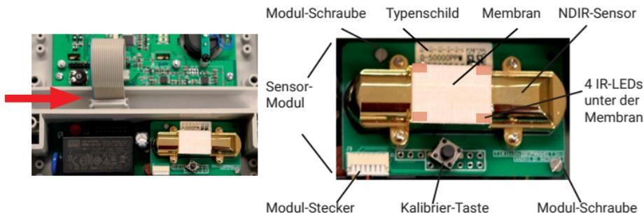
Hebeln Sie vorsichtig mit einem kleinen Schraubendreher den Stecker vom Sensor-Modul heraus. Wechseln Sie dabei ein paar mal die Seiten um den Stecker möglichst gerade heraus zu bekommen. Ziehen Sie keinesfalls an den Leitungen! Drehen Sie die beiden Schrauben aus dem Sensor-
