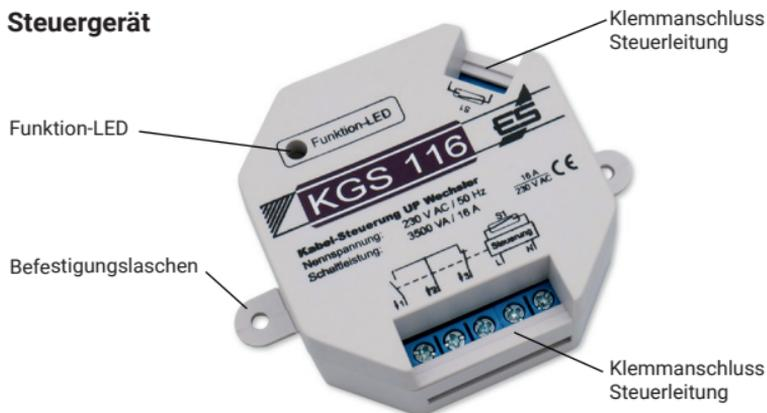
Durch die Kabel-Abluftsteuerung KGS 116 kann das Abluftsystem nur dann benutzt werden, wenn das Verbrennungssystem (z.B. Gastherme) ausgeschaltet ist. Ideal für den nachträglichen Einbau bei einer bereits verlegten 2-adrigen Steuerleitung! Der KGS 116 kann nur Schließerkontakte abfragen. Ein Schließer ist geschlossen, wenn die Gastherme gezündet ist.
