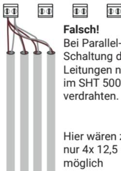
**Falsch!** Bei Parallel-Schaltung die Leitungen nicht im SHT 5000 verdrahten.
