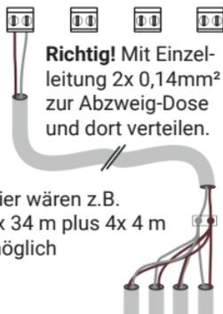
**Richtig!** Mit Einzelleitung 2x 0,14mm<sup>2</sup> zur Abzweig-Dose und dort verteilen.
