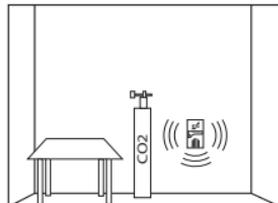
CO<sub>2</sub> aus Flaschen, bzw. sublimiert aus Trockeneis sinkt nach unten und sammelt sich bei unzureichender Durchlüftung in Bodennähe. In den Ecken kann es zur Totraumbildung kommen und die Alarmierung verzögern. Je nach CO<sub>2</sub>-Quelle hat die Positionierung Einfluss auf die Empfindlichkeit und die Häufigkeit der Meldungen. Je weiter oben das Gerät positioniert wird, desto unempfindlicher wird es.
