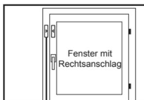
7. Befestigen Sie Magnet und Schaltkontakt durch die mitgelieferten Schrauben am Fenster. Die Pfeile auf den beiden Gehäusen müssen zueinander zeigen und der Abstand darf nicht größer als 0,5 cm sein. Die Distanzplatten dienen zum Höhenausgleich, damit Magnet und Magnetschalter bei geschlossenem Fenster auf gleicher Höhe sind. Verlegen Sie das Steuerkabel und befestigen dies mit den beiliegenden Kabelschellen.
