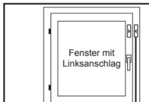
6. Bei geöffnetem Fenster muss der Abstand zwischen Magnetschalter und Magnet min- destens 20 mm betragen. Dadurch wird ein sicheres Ein- und Ausschalten des Senders gewährleistet.
