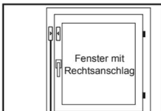
**4.2.8** Positionieren Sie den Kabel-Magnetschalter so am Fenster, dass das erforderliche Spaltöffnungsmaß des Fensters überwacht wird. Sobald beim Schließen des Fensters das erforderliche Spaltöffnungsmaß unterschritten wird, muss das Abluftsystem abschalten. Bei geöffnetem Fenster muss der Abstand zwischen Magnetschalter und Magnet mindestens 20 mm betragen. Dadurch wird ein sicheres Ein- und Ausschalten des Kabel-Magnetschalters garantiert.
